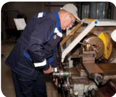
Суть работы **ТОКАРЯ** заключается в обработке материалов (металл, оргстекло, пластмасса и т.д.) на токарно-винторезном станке. Он вытачивает запчасти и детали, которые нуждаются в особой точности. В своей работе токарь следует чертежам. Токарь должен обладать точным линейным и объемным глазомером, хорошей зрительно-моторной координацией, техническим мышлением, пространственным воображением, устойчивостью внимания. Токарь должен хорошо знать геометрию и физику, механику и электротехнику.
