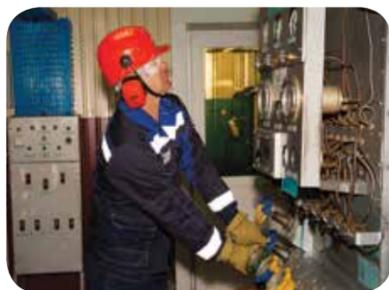
**АППАРАТЧИК ВОЗДУХОРАЗДЕЛЕНИЯ** обслуживает кислородные и кислородно-аргонные установки. В его обязанности входит продувка осушительных батарей, влагоотделителей воздушных компрессоров и декарбонизаторов, слив жидкого кислорода в стационарные и транспортные танки, участие в текущем ремонте оборудования, наблюдение за состоянием давления в рампе и наполнение баллонов. Аппаратчик должен хорошо знать физику, химию и электротехнику.
